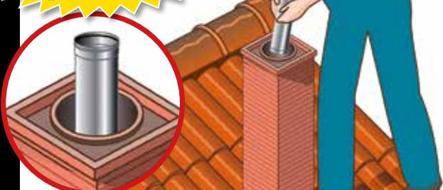
Esempi di inserimento di più condotti di sezione circolare
